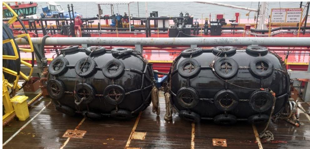
**X** 气动挡泥板应从其任一端的起吊点起吊，而非从轮胎和链网起吊。应使用经认证的吊索或绳索进行起吊。
