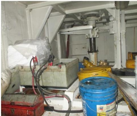
**X** 舵机室内电池以及可燃物、化学品和其他散乱的设备暴露在外。
