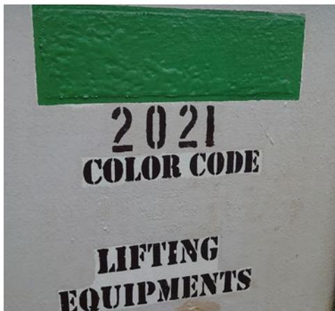
**✓** 建议使用彩色编码系统，以便船员轻松识别可拆卸起重设备各零部件的上次年检情况。
