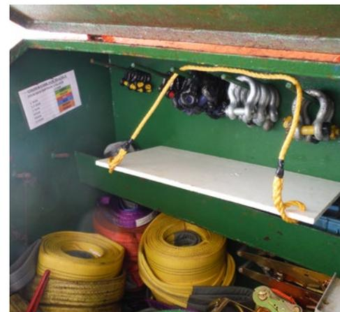
**✓** 卸扣用不同颜色标记，指示安全工作负荷/工作负荷限制以及和上次检查年份。
