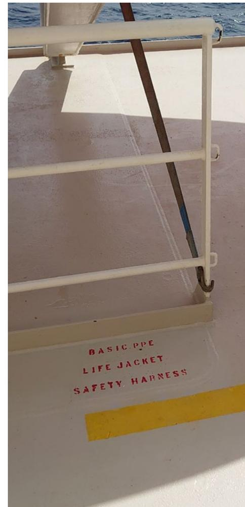
作业员使用彩色编码线标明个人防护装备要求。图示情况下，在黄线外移动时需要穿戴基本的个人防护装备、救生衣及坠落防护装备。
