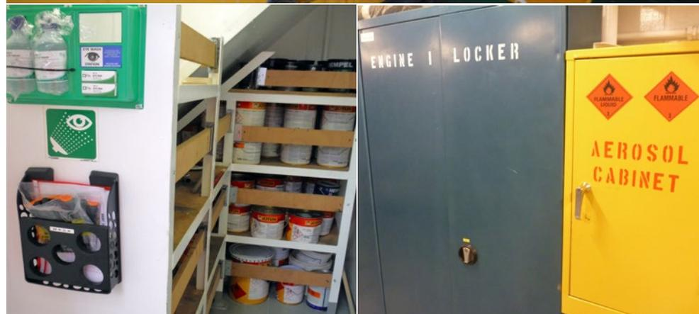
✓ 油漆和其他易燃物以安全稳当的方式积载，且化学品安全技术说明书（SDS）、个人防护装备（如护眼装备）和应急洗眼瓶可随取随用。按照适用规定采取了消防措施。
