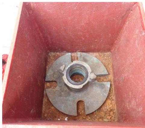
**X** 国际通岸接头没有用垫片螺栓、螺母和垫圈连接在一起。
