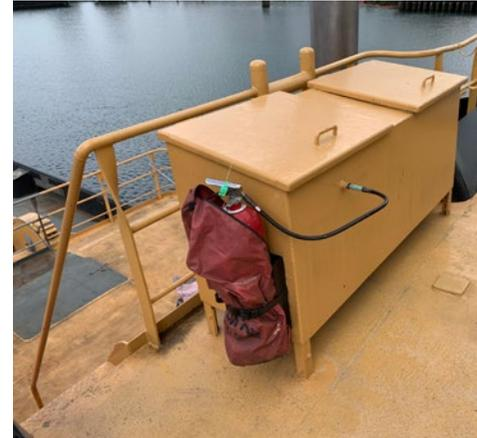
✓ 露天存放的便携式和推车式（移动式）灭火器受到保护，需要进行例行检查和定期换新。
