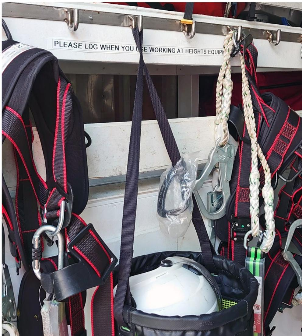
✓ 装有各种个人坠落防护装备（包括各种尺寸的全身式安全吊带）的高处作业设备柜。
