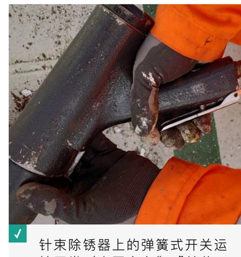
✓ 针束除锈器上的弹簧式开关运转正常（未固定在“开”档位上）。
