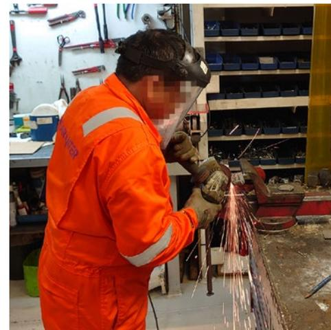
✓ 角磨机上装有安全防护装置，使用时佩戴面罩和手套。
