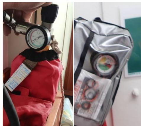
**X** 紧急逃生呼吸装置压力表显示气瓶是空的。
