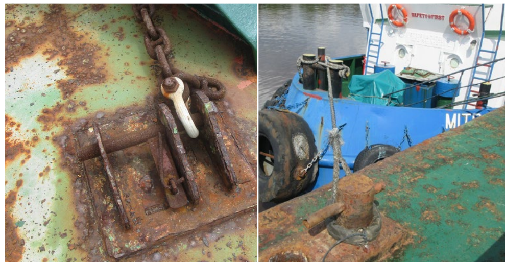
X 應對艙面屬具進行保養並上鋼塗層，防止損耗。
