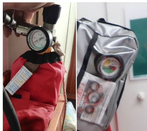
X 緊急逃生呼吸裝置壓力錶顯示氣瓶是空的。
