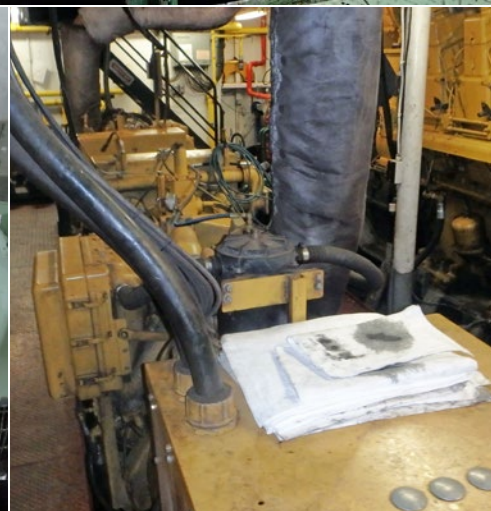
✓ 隔熱材料處於良好的無油狀態，緊密貼合，無暴露出熱表面的缺口。
