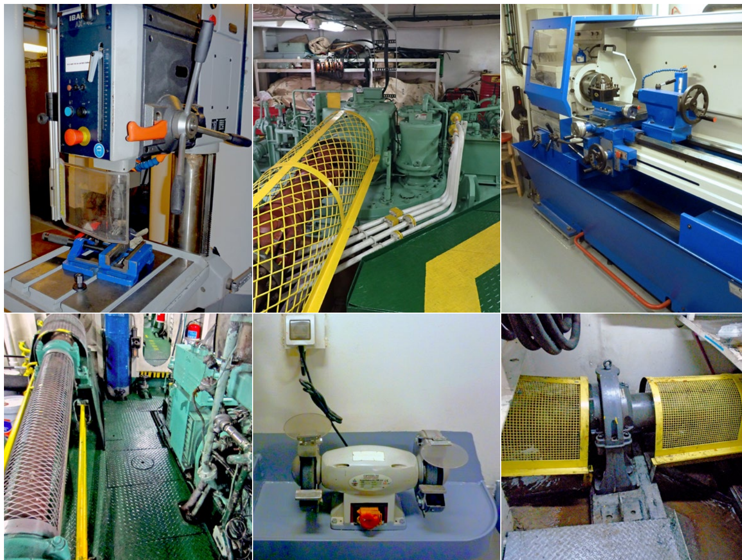
正確安裝防護裝置的旋轉機械
