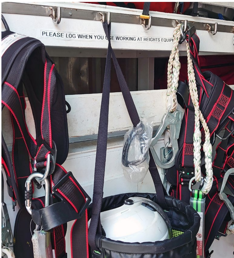
✓ 裝有各種個人墜落防護裝備（包括各種尺寸的全身式安全吊帶）的高處作業設備櫃。
