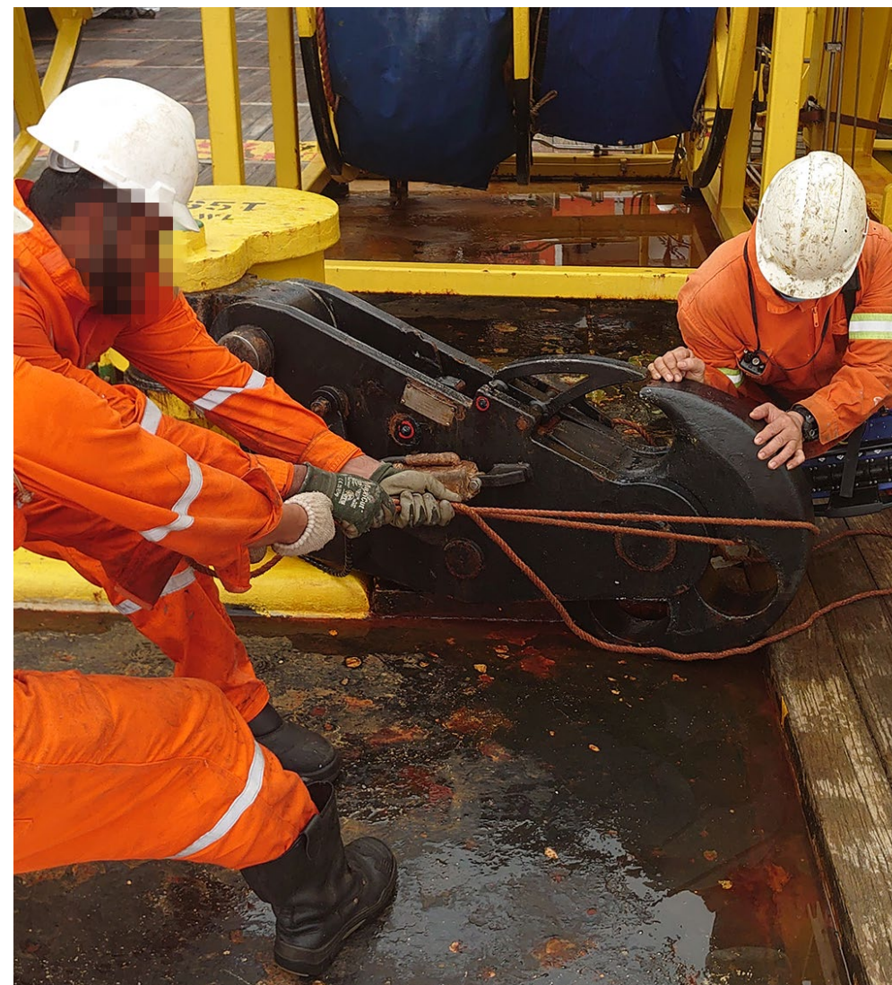
船員在利用就地和遠端（駕駛台）控制完成培訓課程後，重新設置速脫鉤。
