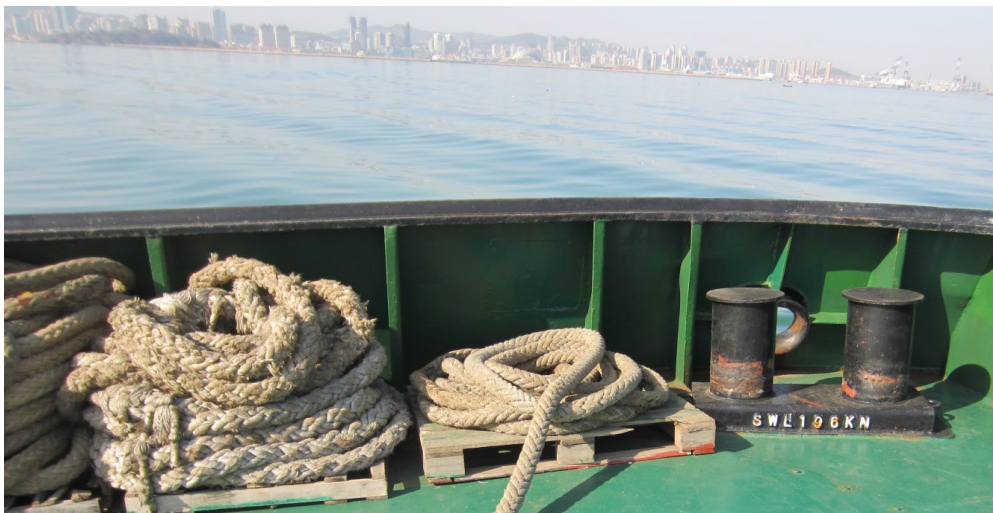
X 繩索存放在甲板上，但未採取防曬和防風雨措施。
